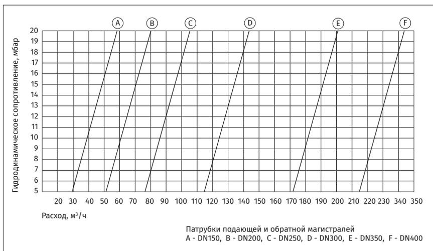
График 1 - Гидродинамическое сопротивление отопительного контура
