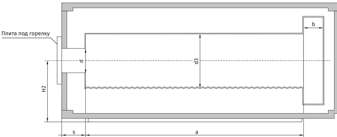
Рисунок 3 - Присоединительные размеры для монтажа горелки
