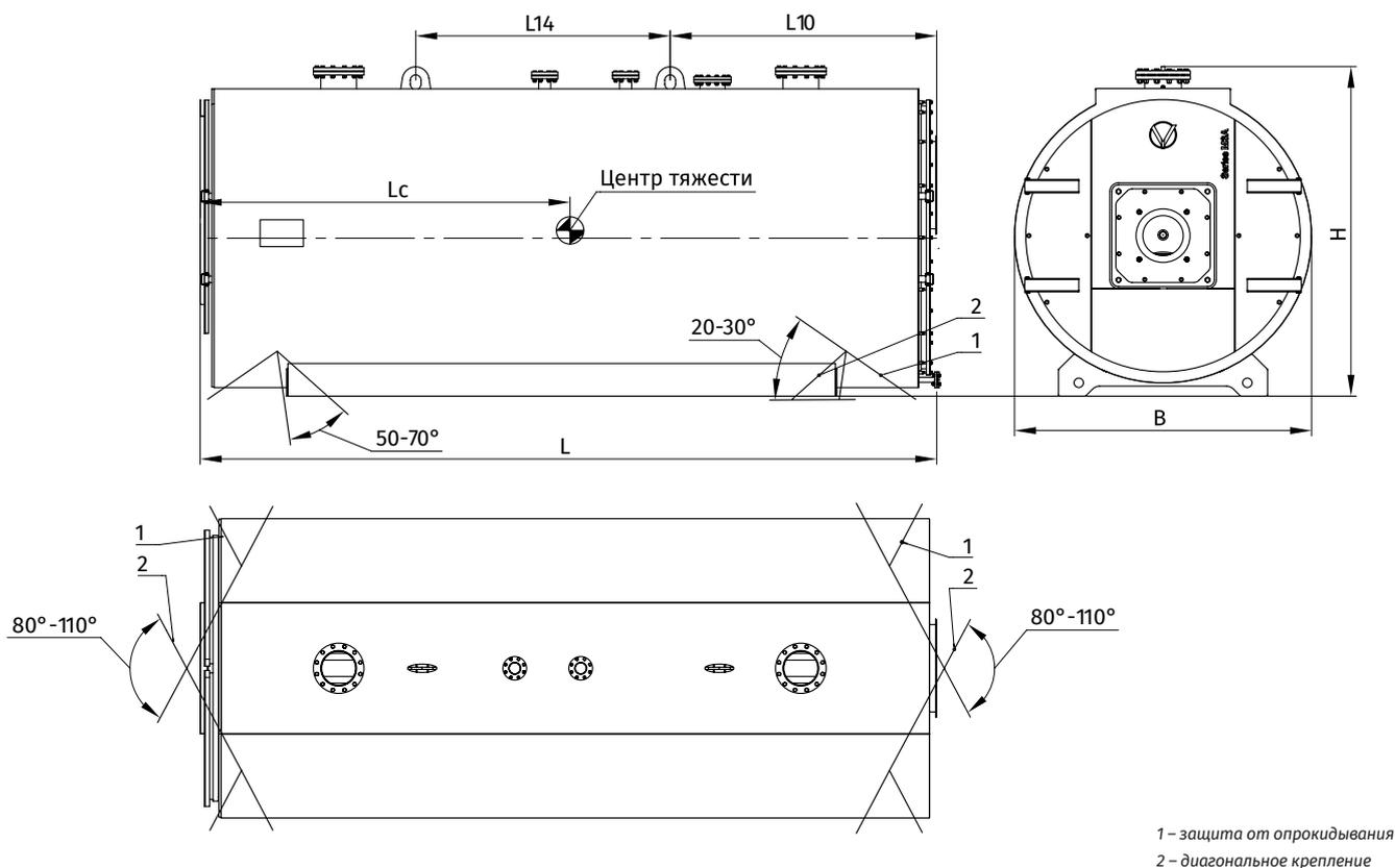
Рисунок 4 - Схема строповки и габаритные размеры
